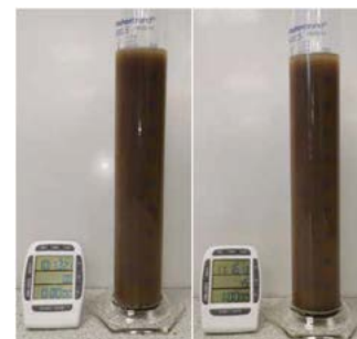
Décantation de l'argile au bout de 60 minutes
